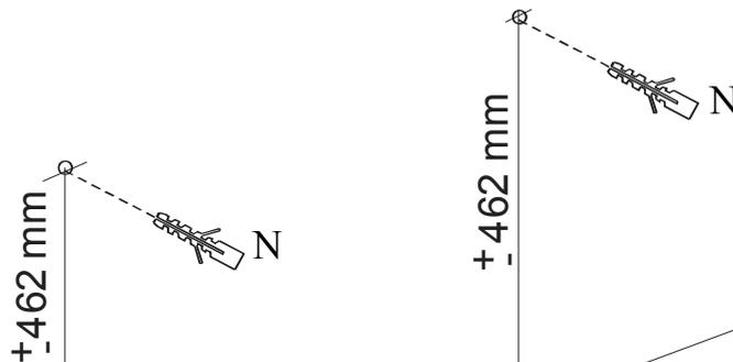
Por favor, use uma furadeira para fixar os parafusos na parede.
